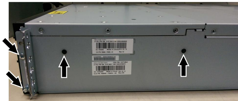
Figura 105. Parafusos da lateral direita do gabinete
