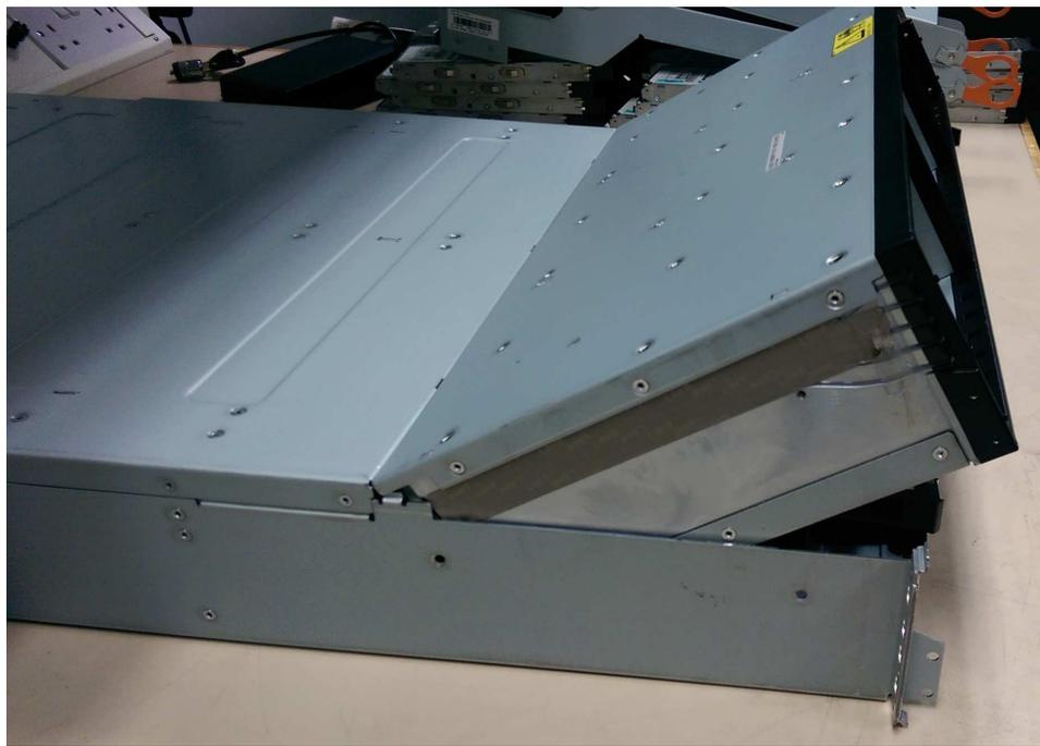
Figura 107. Montagem do painel intermediário angular
