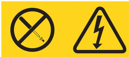
Voltagens, correntes e níveis de energia perigosos estão presentes dentro de qualquer componente que tenha essa etiqueta afixada. Nenhuma peça localizada no interior desses componentes pode ser consertada. Se você suspeitar de um problema com alguma dessas peças, entre em contato com um técnico.
