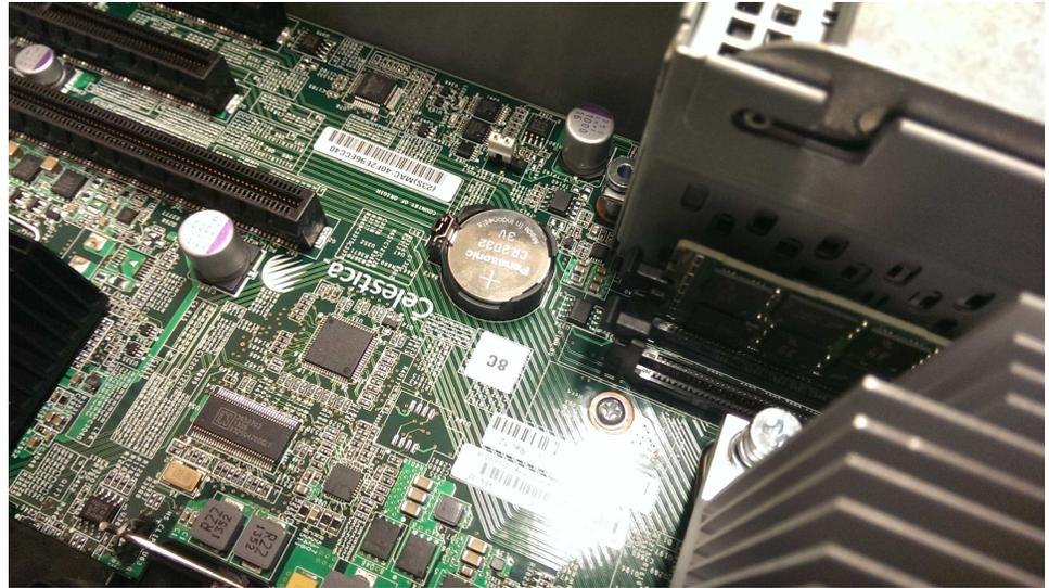
Figura 119. Substituindo uma bateria Gen2 do CMOS
