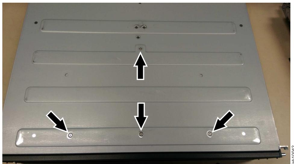
Figura 104. Parafusos do gabinete inferior
